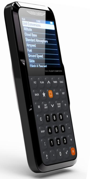
**Ergonomisches Design.** Der CX3 hat eine schlichte Tastatur und ein schlankes Design. Die rutschfeste Hülle schützt Ihren Computer im Pilotenkoffer und passt auf dessen Rückseite für eine einfache Lagerung während das Gerät in Benutzung ist.
